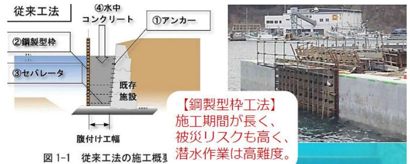
図 1-1 従来工法の施工概要
